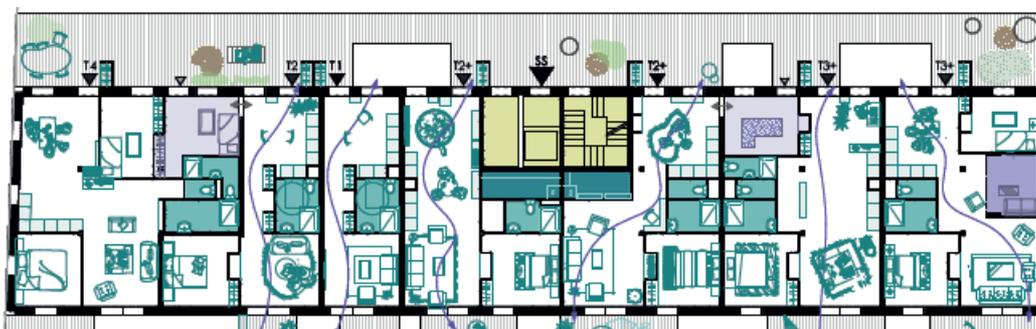
*La distribution des 5 niveaux de logements traversants définit une trame fixe pour les pièces humides centrées (en vert) et permet dans le reste du logement l'appropriation et les usages souhaités par les locataires. La dévolution des pièces pourra s'adapter en fonction de l'évolution du foyer, de l'âge, ...*
